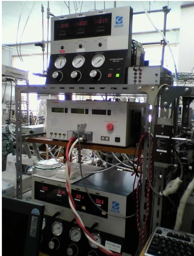
ガス供給系: H<sub>2</sub>ガス混合器、電子負荷器(司測研)、O<sub>2</sub>ガス混合器
