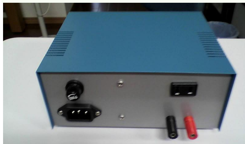
ヒーター及び熱電対接続部(右側)
